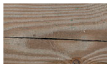
Spannungsrisse durch die Holz Trocknung
