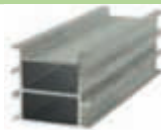
Alu Unterkonstruktionsschiene Relo K Empfehlung: Achsabstand 40-45 cm Auflagerabstand Achsmaß 55-60 cm
